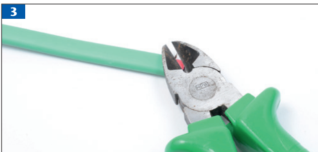
3 Schutzleiter mit dem Seitenschneider sorgfältig abschneiden.
